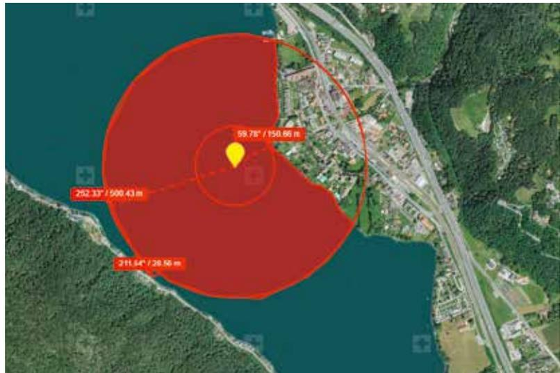
Esempio del raggio di azione di un idrofono: in condizioni ottimali queste apparecchiature sono in grado di captare un segnale a circa 500 metri di distanza.
